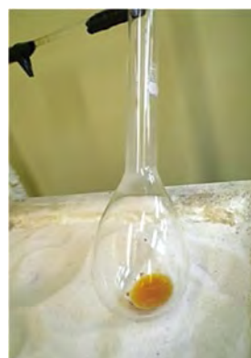
図 2. 化成品の酸分解の様子
