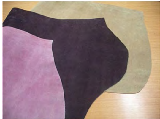
図4. スプレー法によって草木染料で着色したクロム鞣牛床革の半裁革 写真左より、ラックダイ、ログウッド、ザクロ
