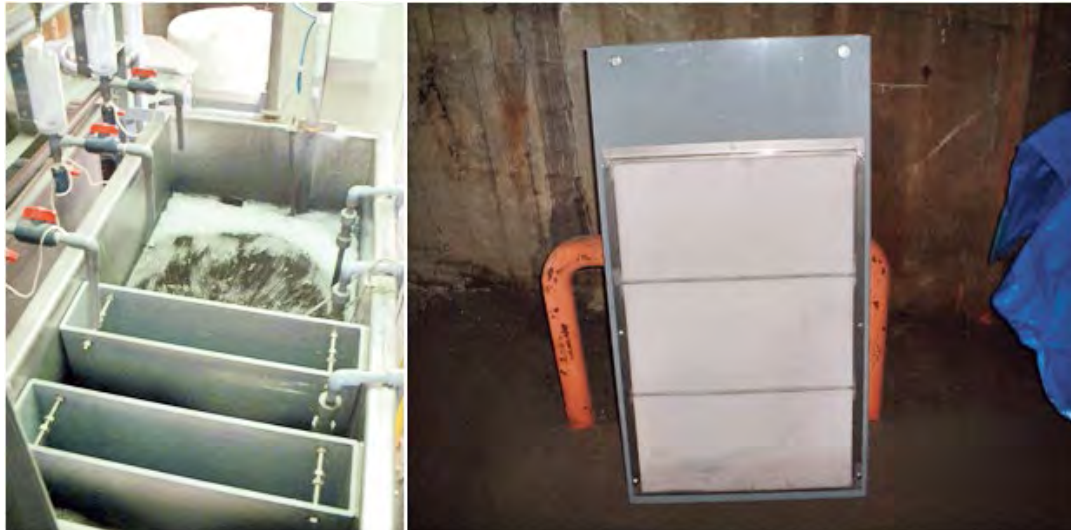
図4. 染色工場に設置した実証実験装置（700L スケール）と固定化材
