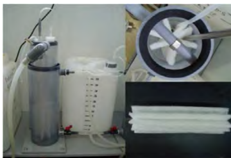
図9. 菊花状不織布を用いたアナモックス菌の集積培養装置
