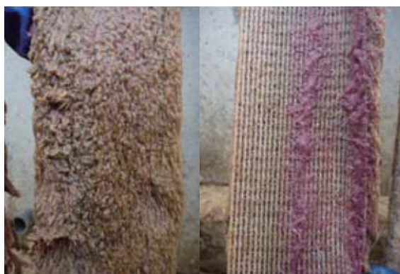
汚泥が付着したパイル織物固定化担体
