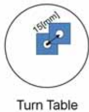
図3．ターンテーブル上における樹脂サンプルの配置
