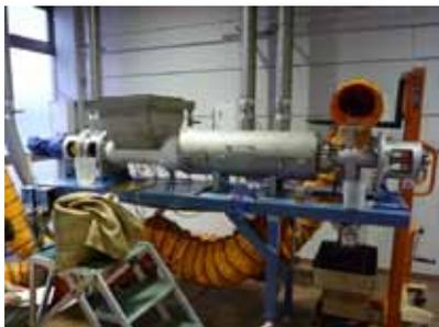
写真 1. スクリー式半炭化炉
