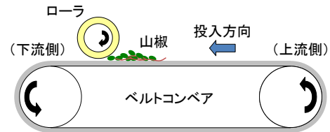
図2. 実を外す装置の概念図
