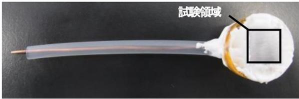
図2. エポキシ樹脂製埋込式電極の外観
