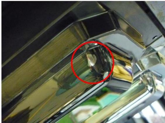
図3 DLCの剥離（丸で囲った部分）
