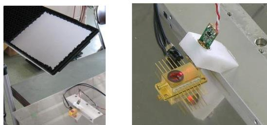
(a) 光走査実験 (b) 真空封止実装パッケージ
