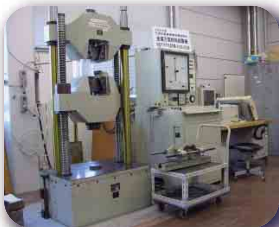
金属万能材料試験機 (株)東京衡機製造所製 RUEⅢ-50G
