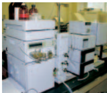
リサイクル型分取HPLC 分子量測定及び分子量分画による分取
