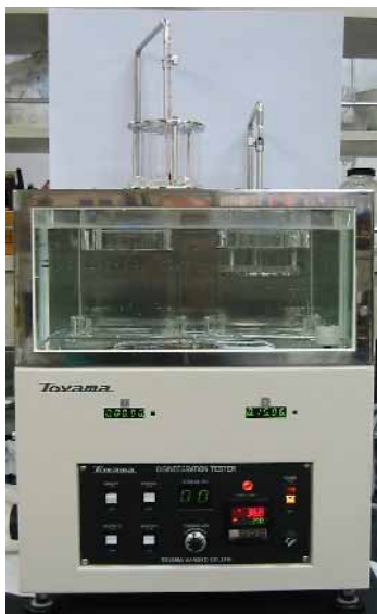
崩壊試験装置
