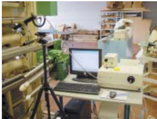
図3 コロナ放電領域を測定中の分光放射計 写真左 コロナ放電処理装置 写真左上(黒色円筒)石英レンズ鏡筒 (光ファイバプローブの先端に接続) 写真左 分光放射計本体
