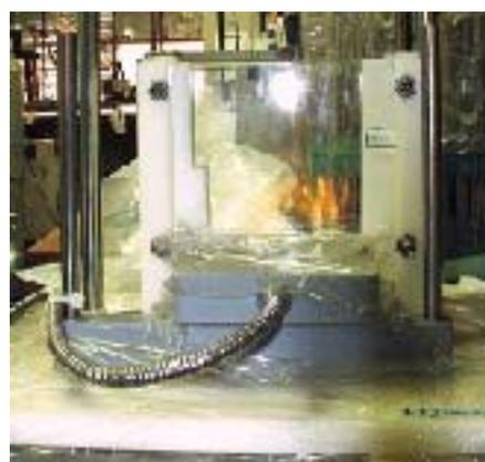
図2 溶解速度モニター
