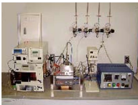
図2．超臨界反応装置
