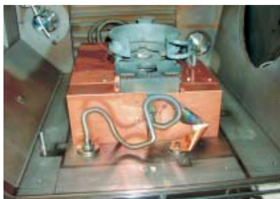
写真：真空チャンパー内、るつぼの写真。真ん中のるつぼにプラズマとなる金属材料を置き、電子銃を用いて加熱する。この後、チャンパー上部に取り付けてある試料に対して金属イオンを加速して注入を行う。るつぼの周りには冷却水が流れている。
