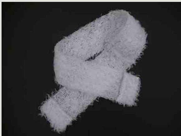
固定化担体用の県産パイル織物
