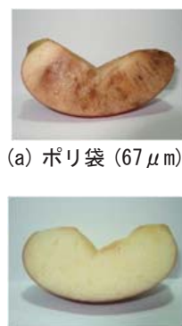
図2 異なる材質での保存実験
