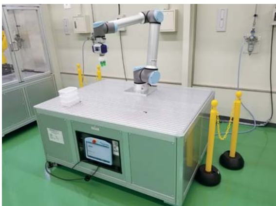
垂直多関節型 UNIVERSAL Robot UR10e
