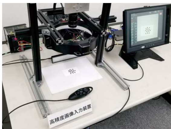
高精度画像入力装置 キーエンス XG-X2900
