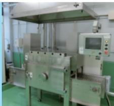
高温の水蒸気で食材を加熱することができます。
