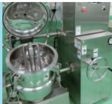
圧力を調整しながら加熱して攪拌調理ができます。
