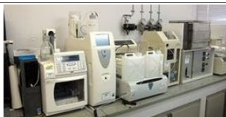
自動燃焼装置付きイオンクロマトグラフ サーモフィッシャーサイエンティフィック製 ICS-21 ヤナコ機器開発研究所製 SQ-5、HSU-35
