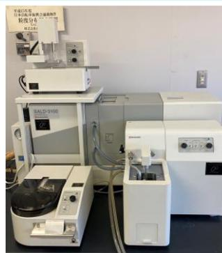
レーザー回折型粒度分布測定装置
