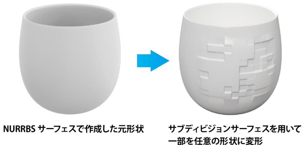
図 20.サブディビジョンサーフェスを活用したエンボス加工
