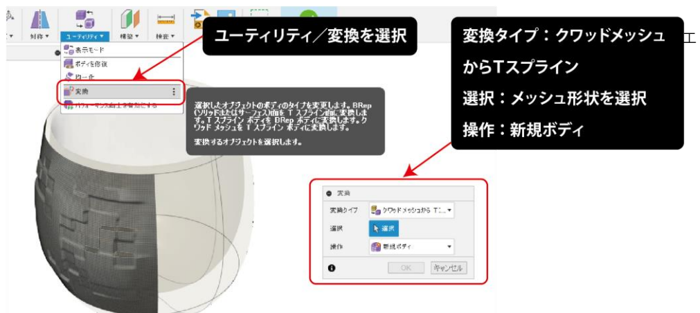
図 32.メッシュデータからサブディビジョンサーフェスへの変換
