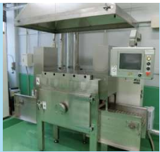
過熱水蒸気発生装置
