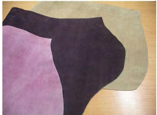
図4. スプレー法によって草木染料で着色したクロム鞣牛床革の半裁革
