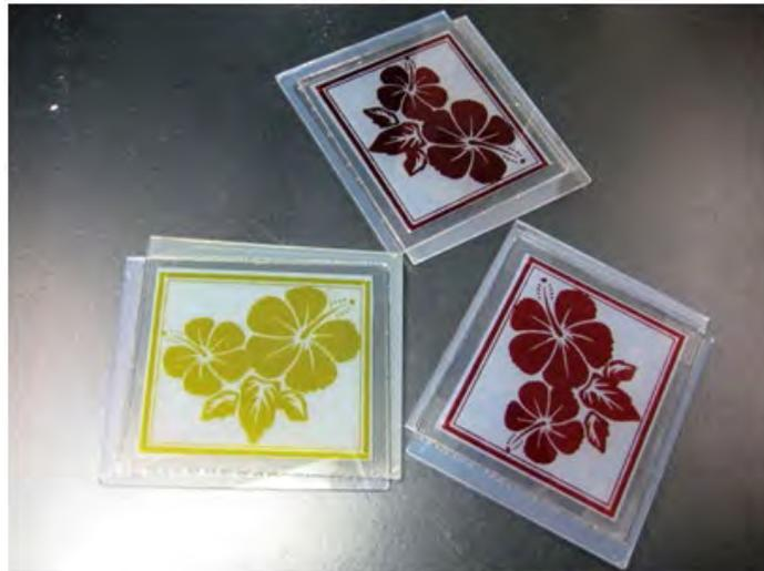
写真 2. 試作した色素増感太陽電池セル
