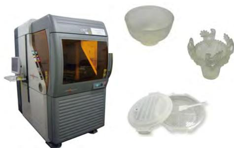
図3. 光造形装置及び造形モデル
