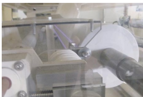
放電処理中の電極と織物
