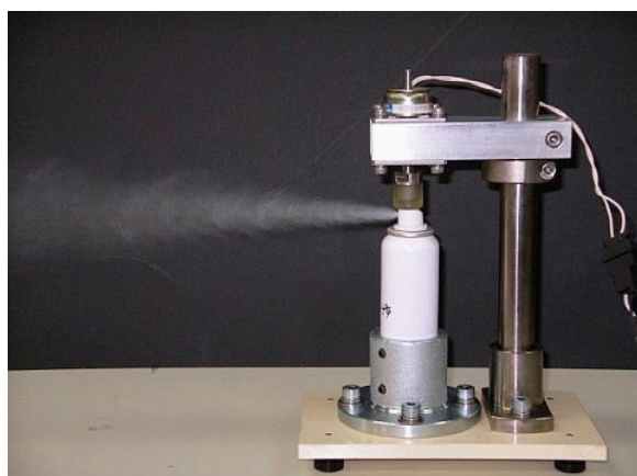
新規に試作したエアゾール噴射量制御装置
