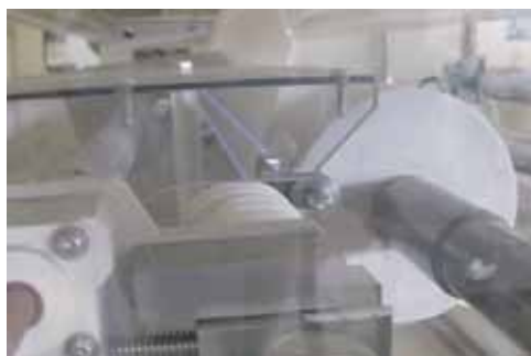
放電処理中の電極と織物
