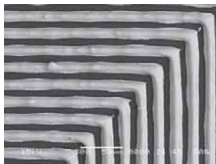
導電性ペースト印刷による電子回路
