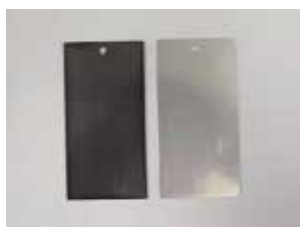
DLC処理を施したステンレス板（左）
