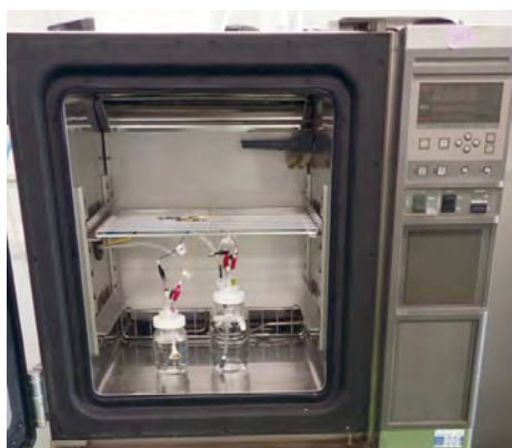
▲浸漬試験中の恒温恒湿槽内部の様子。 使用環境に応じて浸漬溶液の種類や温度 / 湿度を設定することで、実環境に即した耐食試験を行うことが可能です。
