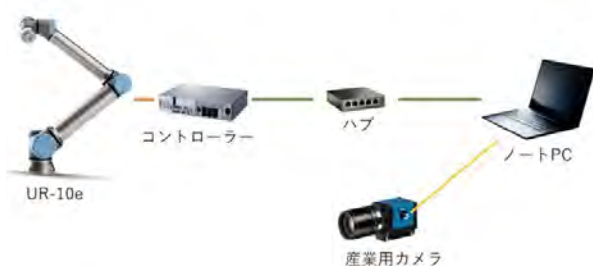
▲ピック&プレース制御システム構成
