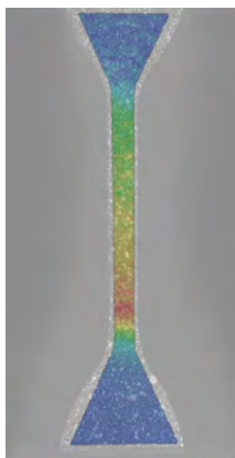
▲非接触 3D 変位・ひずみ分布測定の一例 <ひずみ分布>
