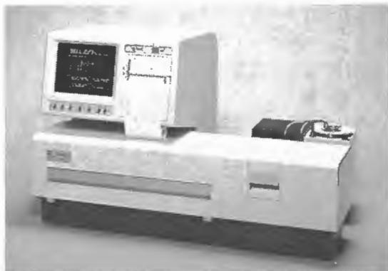
島津レーザ回折式粒度分布測定装置
