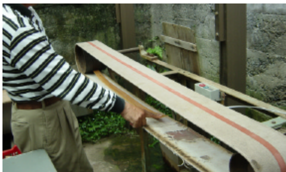
写真2 ローラーで檜材に反りを付ける
