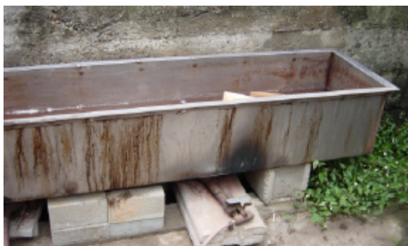
写真1 檜材を沸騰した湯に20分浸漬
