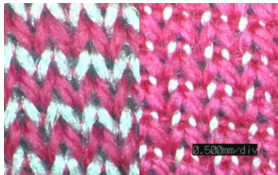
図2 編地拡大写真（左：低張力、右：高張力）
