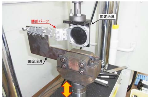
図5. 下肢アシストスーツ腰部フレームの疲労試験
