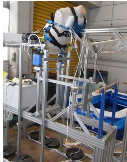
図3. 下肢アシストスーツ繰り返し耐久試験条件
