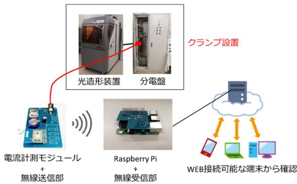
図1 光造形装置監視システムの概要
