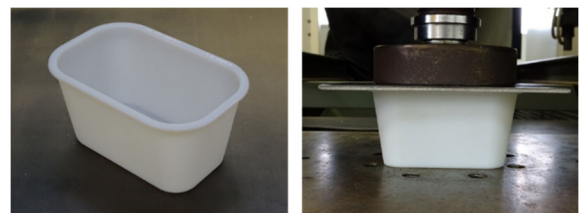
図11 材料試験機による圧縮試験
