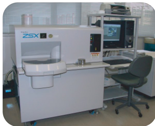
蛍光X線分析装置 リガク電機(株)製 ZSX100e
