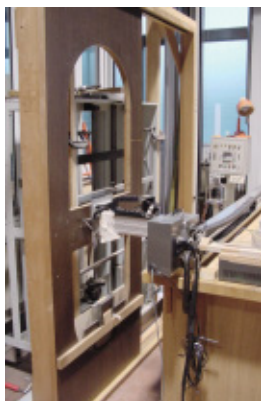
扉の開閉試験
