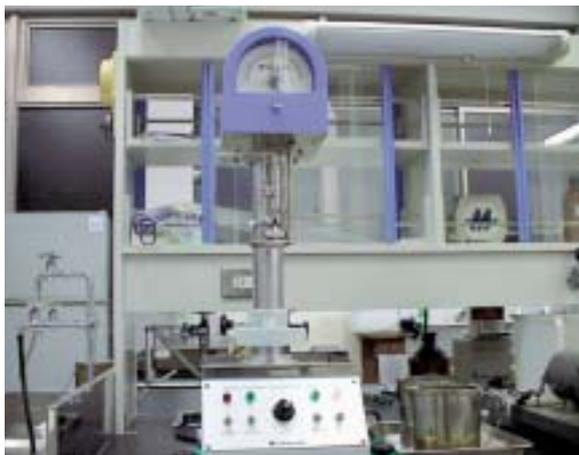
液中熱収縮温度測定装置
