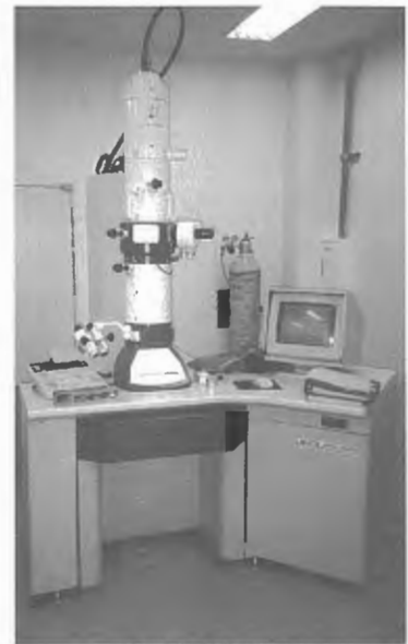
透過型電子顕微鏡
