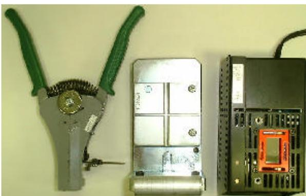
図2 SI-POFの端面加工ツール
