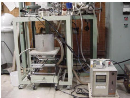
図2 バッチ式発泡装置
