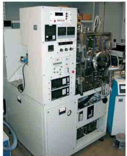
図3 真空蒸着装置
