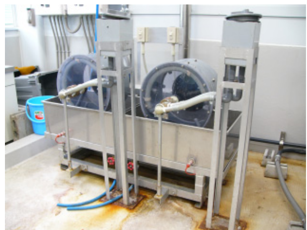
写真2 試験用鞣し装置
