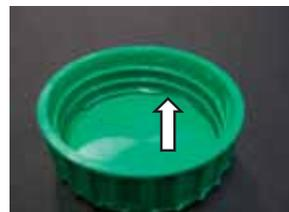
図5. 割れた瓶のキャップの破壊起点
