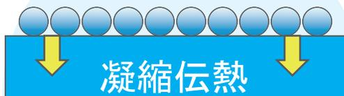
表面温度が低いときは、コップに水が結露する現象と同様に凝縮水がサンプルの周りを取り囲み主に凝縮伝熱が起き、サンプル重量は増加。
