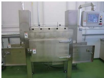
コンベアにより過熱水蒸気の中をサンプルが通過
