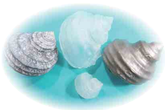
天然貝殻（左）、CTで取得した3次元データを用いた 光造形モデル（中）とNCフライス盤で切削加工した金属モデル（右）
