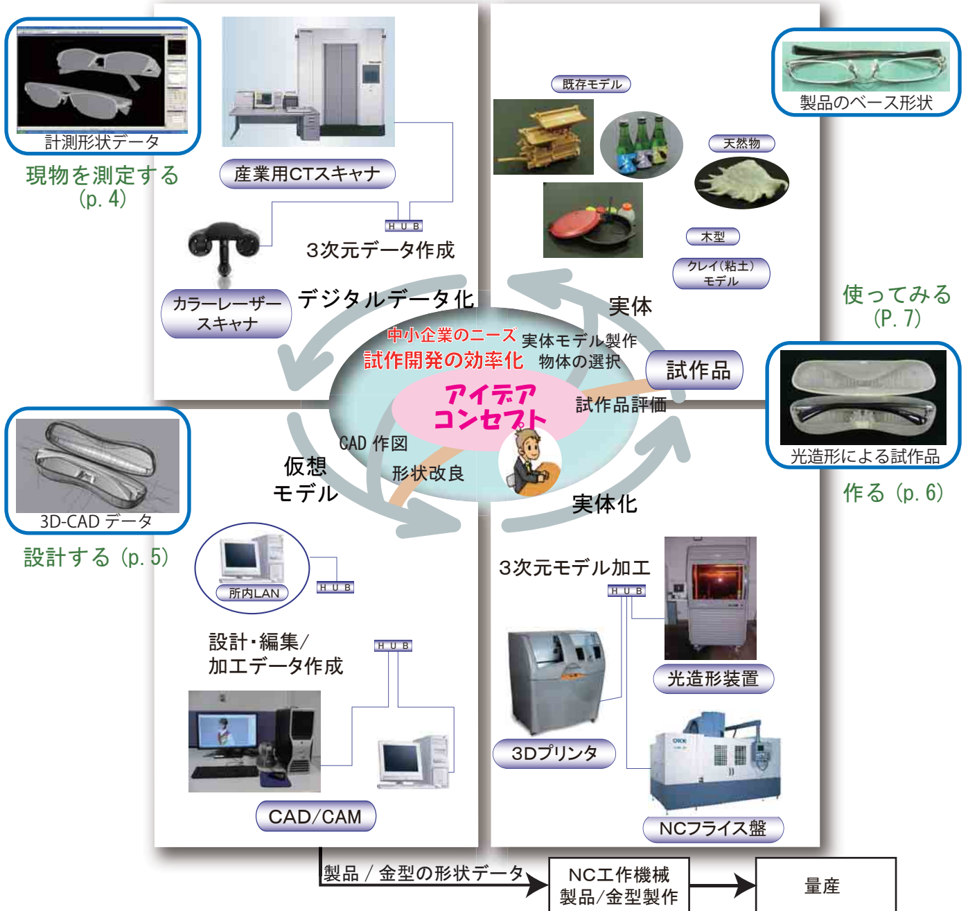
和歌山県工業技術センターが行っているデジタルエンジニアリングによる試作開発支援のイメージ
