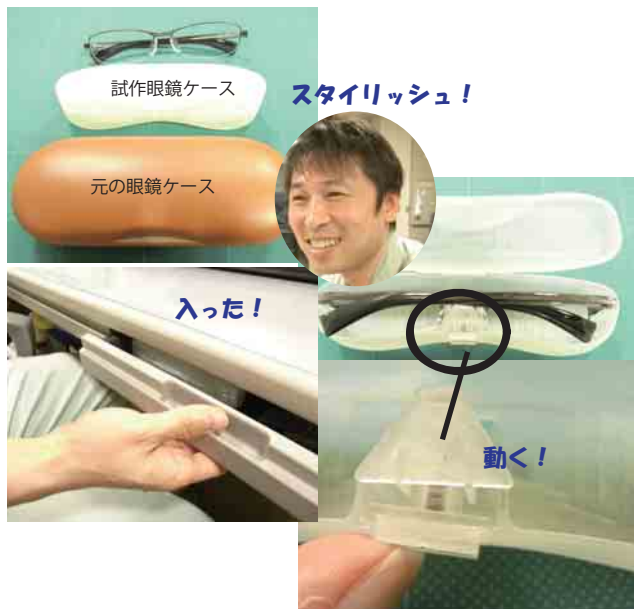
開閉ストッパーの造形・動作確認
