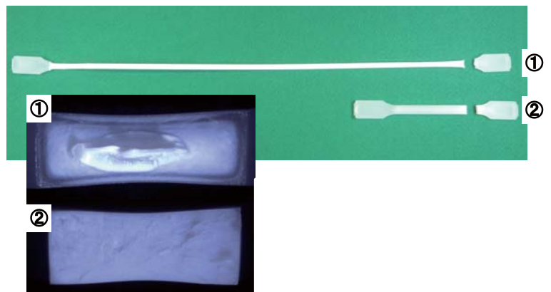
図2 引張試験後の試料概観と破断面 (上: ①、下: ②)
