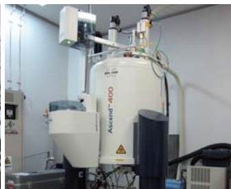
超伝導核磁気共鳴装置 (NMR)
