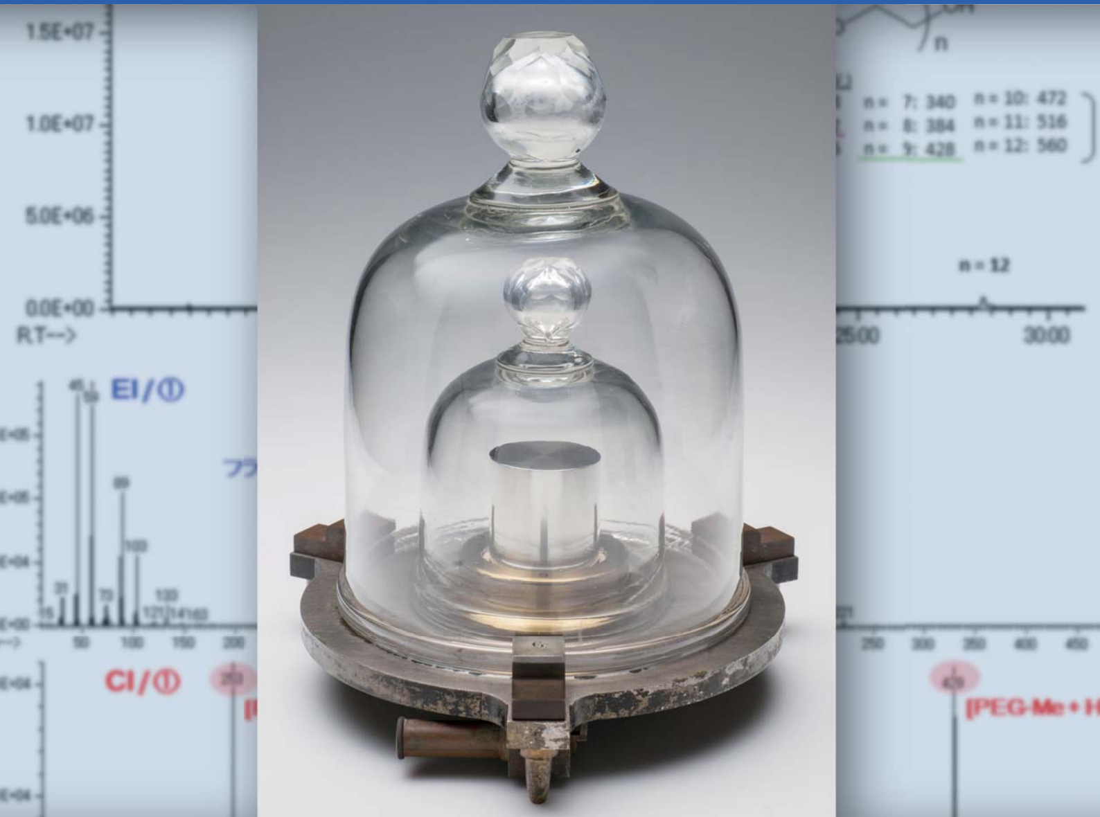
日本国キログラム原器 [不許複製] ©国立研究開発法人産業技術総合研究所
