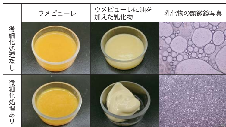
図4 微細化による乳化安定性の違い
