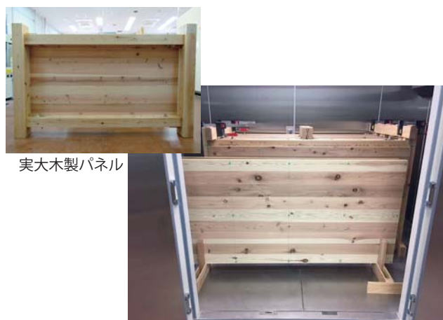
図 1 実大木製パネルの環境試験
