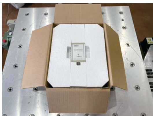
図 2 ポータブル加速度計を入れた梱包試料
