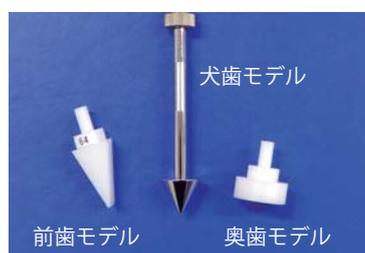
図1 試験に用いた治具
