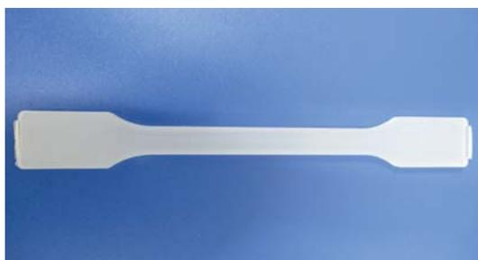
引張試験の試験片（ダンベル型試験片）
