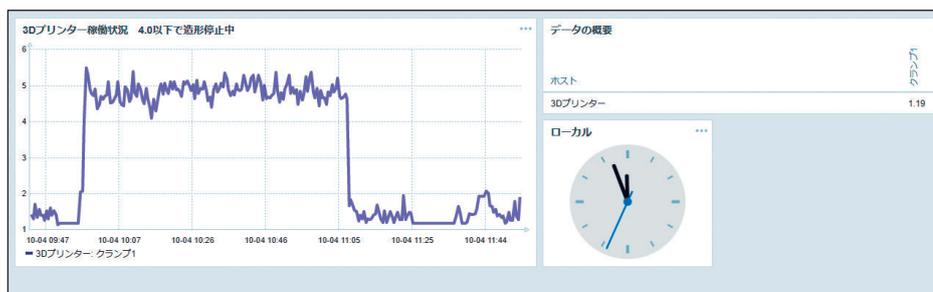
図2 IoT用クラウドサービスでの稼働状況可視化画面
