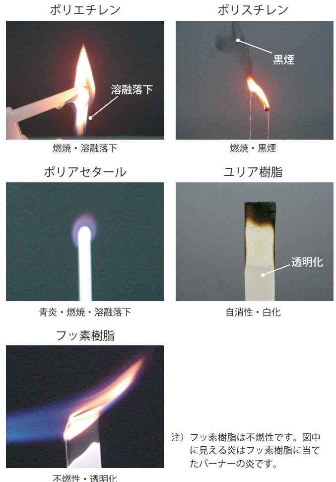
図2 プラスチック材料の燃焼の様子
