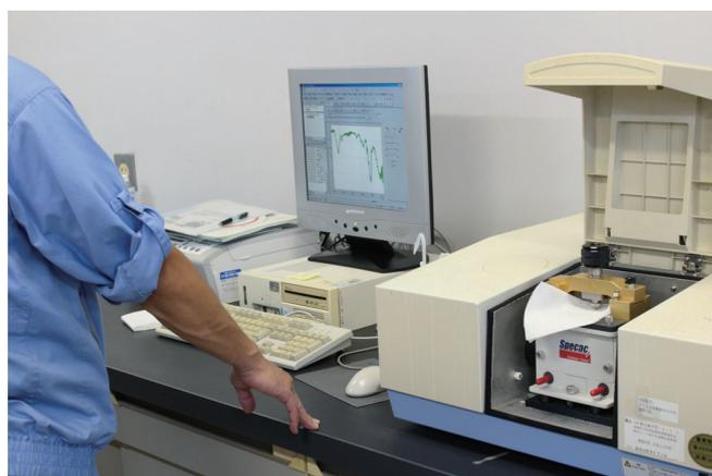
図1 技術研修会（フーリエ変換型赤外分光光度計（FT-IR）での実機を用いた研修の様子
