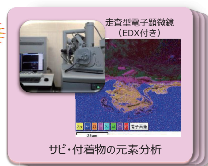
腐食トラブルに関する技術支援
