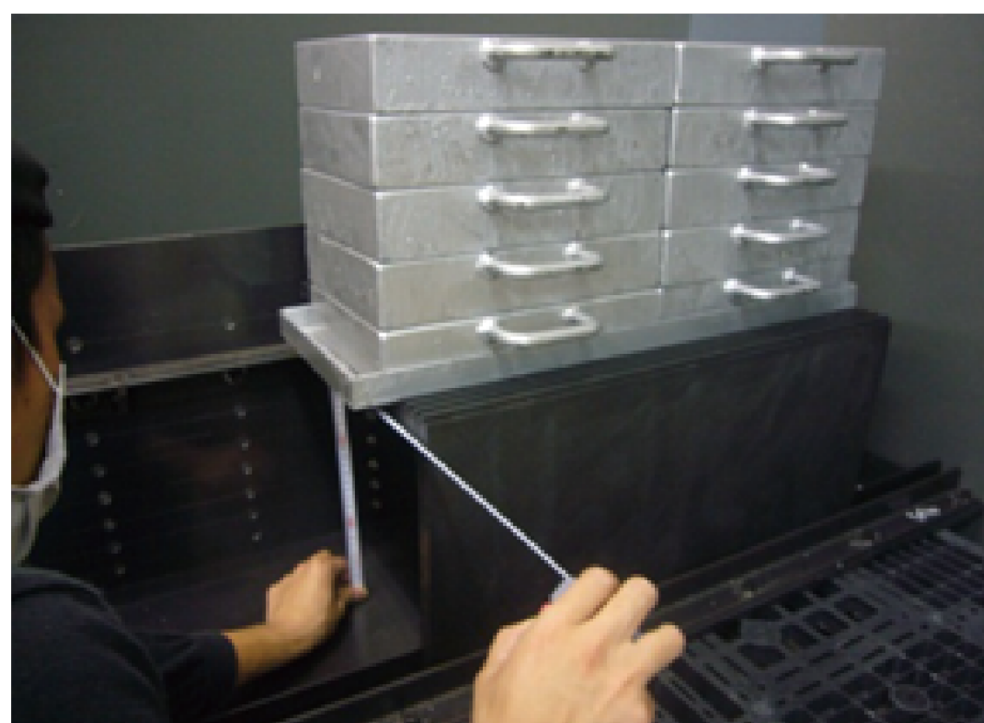
性能評価試験 荷重検査試験
