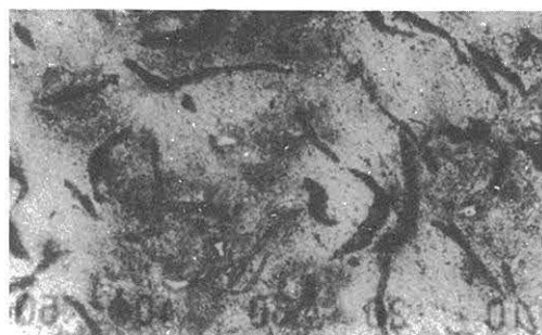
写真1 Ni0.06%の組織 倍率200倍、腐食液5%ピクル
